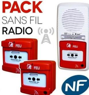
Le type 4 radio peut être interconnecté à plusieurs déclencheurs manuels (10 maxi) ou autre alarme de type 4 par liaison radio. Lorsque un des déclencheurs manuels (DM) interconnectés est actionné, l'alarme du type 4 associé est déclenchée.
